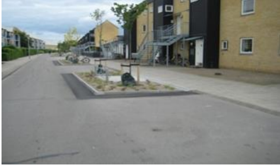
Abb. 79: Einbau eines Grünbeetes 82 und von Radabstellplätzen im Straßenraum 83
