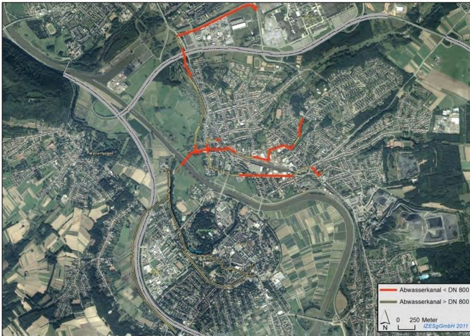
Abbildung 11-6: Karte mit Abwasserkanälen in der Stadt Saarouis für einen potenziellen Einbau von Wärmetauschern
