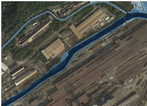
Abb. 8: Ergebnis Überflutungstiefen Modell IST-Zustand (Rechenlauf 19) in [m]
